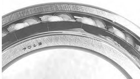
Рис. 1.20 Наполненный смазкой цилиндрический роликовый подшипник
