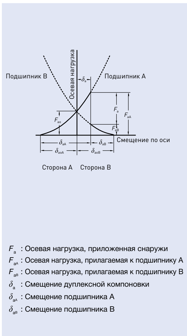
Рис. 4.4 Смещение по оси компоновки DB с преднатягом
