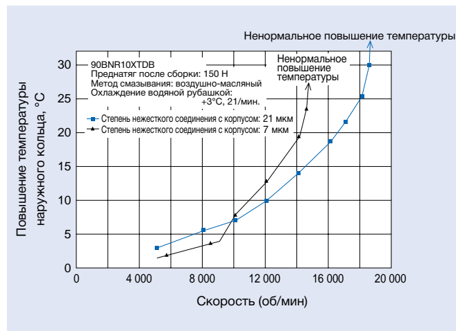
Рис. 5.3 Влияние зазора между подшипником и корпусом на предельную скорость
