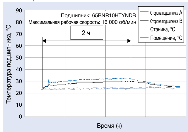
Рис. 3.3 Изменение температуры при прерывистом режиме работы
