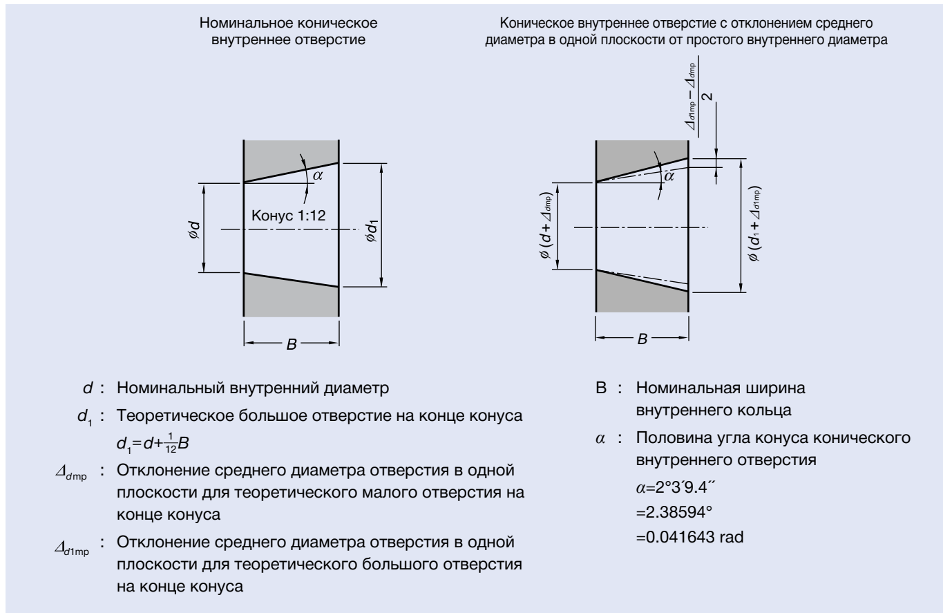
Рис. 7.3 Допустимые отклонения конического внутреннего отверстия
