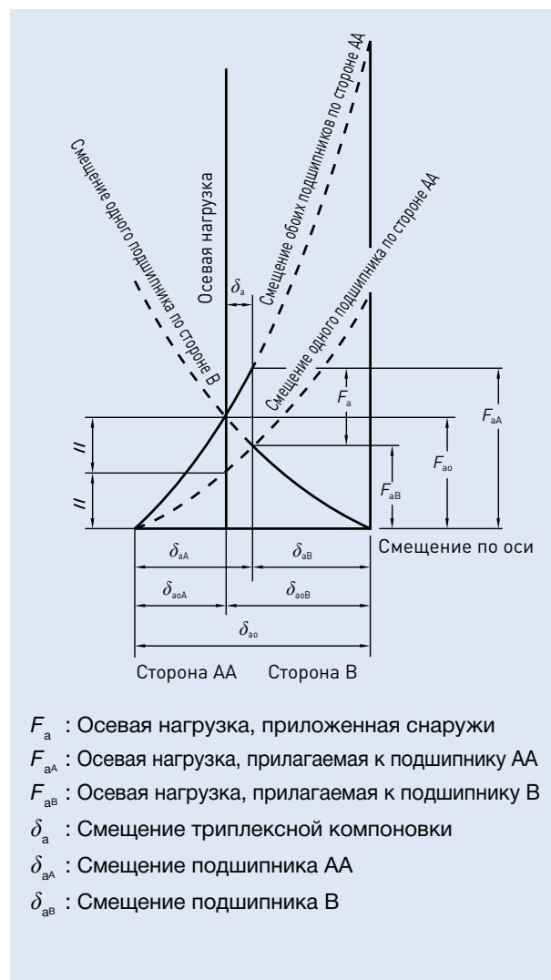
Рис. 4.6 Смещение по оси компоновки DBD с преднатягом
