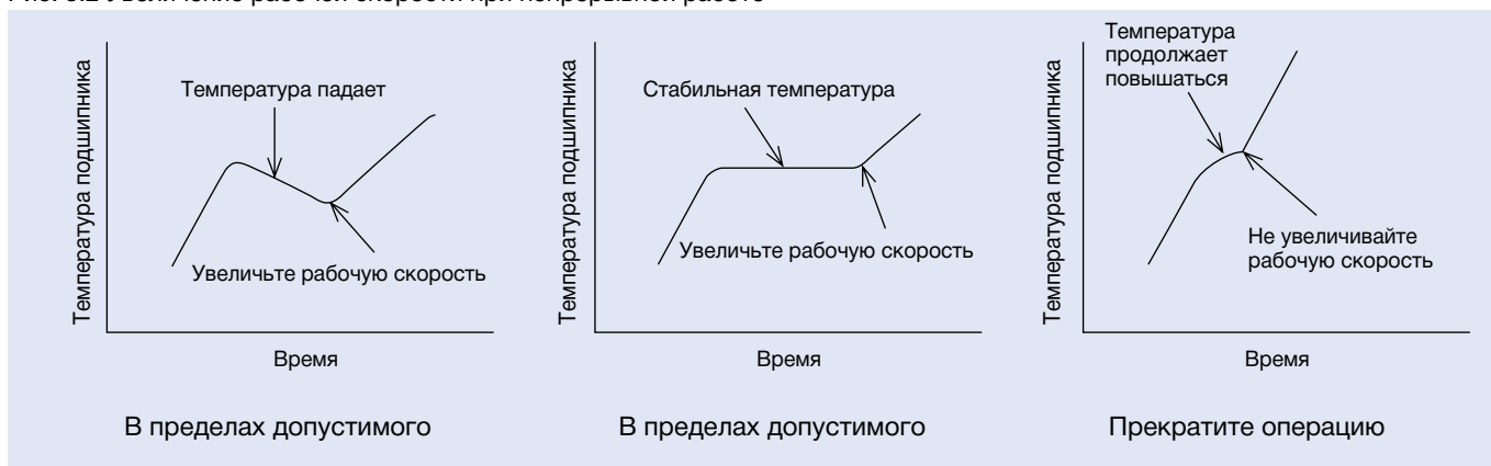
Рис. 3.2 Увеличение рабочей скорости при непрерывной работе
