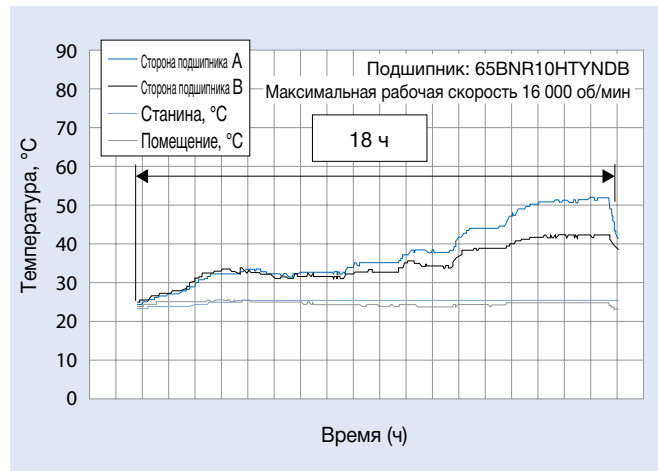
Рис. 3.1 Изменения температуры при работе с постоянной скоростью
