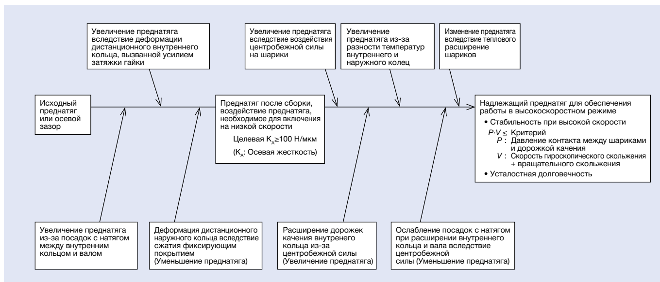
Рис. 5.1 Схема регулирования преднатяга
