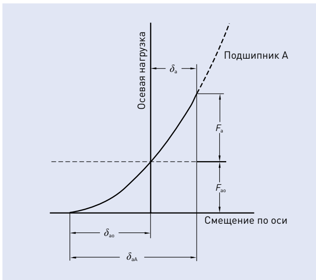
Рис. 4.7 Смещение по оси при предварительной нагрузке постоянного давления
