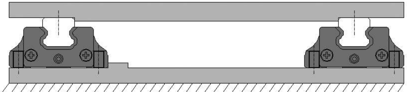
(B) Auf horizontaler Ebene mit festen Gleitstücken (B) На горизонтальной поверхности с закрепленными блоками
